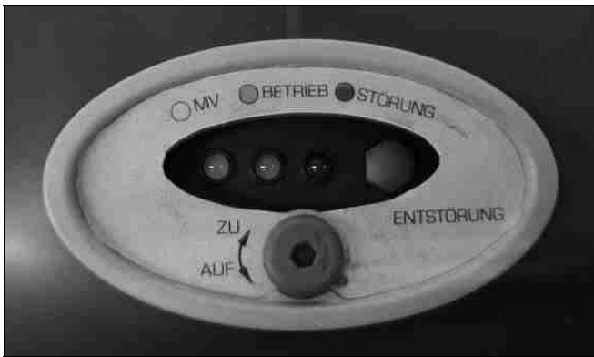
Εικόνα 1: Πίνακας λυχνιών GE 1H κίτρινο LED ⬆ Μαγνητική βαλβίδα,; πράσινο LED ⬆ Λειτουργία; κόκκινο LED ⬆ Βλάβη, / Κουμπίαποκατάστασης βλάβης
